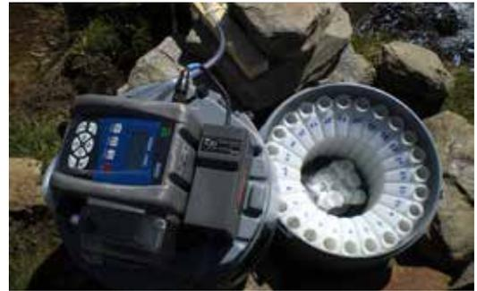
Abb. 5.3 – Automatischer Wasserprobensammler an der Pegelstation Hochebenkar.
