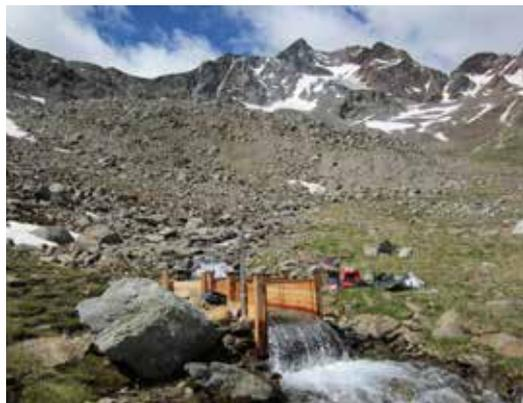
Abb. 4.1 – Pegelmessstelle zur Untersuchung des Abflussverhaltens des Lazaun Blockgletscherbaches.
